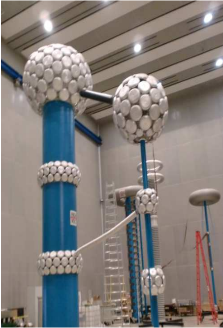
Links: Teslaspulen in der Hochspannungshalle der BTU zur Erzeugung von Spannungen bis 1,8 Mio. Volt
